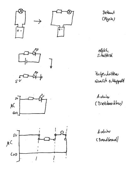
Bekannt aus dem experimentellen Aufgabe des Physikunterrichts der Mittelstufe sind Schaltbilder in der "Physikdarstellung", welche nicht direkt der der Elektronik/Elektrotechnik entspricht. Hier sind – noch recht einfache – Gewöhnungsleistungen zu erbringen und durch Gebrauch und Übungen zu verinnerlichen.
