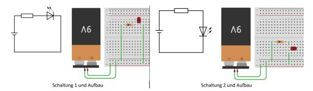
Ein Steckbrett hat eine besondere Struktur, die hier nicht berücksichtigt wurde, der häufigste Fehler – neben Wackelkontakten – beim Arbeiten mit Steckbrettern. Eine Spalte ist Durchverbunden, die Spannungsversorgungsreihen '+' und '– , sind ebenfalls durchverbunden:
