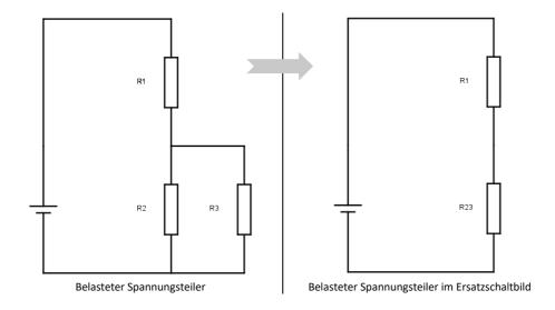
a) Berechnen Sie den Ersatzwiderstand  $R_{23}$  für eine Spannungsquelle von 9 V und  $R_2$ = $R_3$ =470 Ohm,  $R_1$ =100 Ohm.
